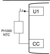
Agli ingressi universali del dispositivo possono essere connesse sonde di temperatura Pt100 e NTC. La programmazione dell'ingresso per la lettura di sonde di temperature Pt100 e NTC deve essere selezionata attraverso il software di programmazione.
