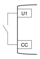
Agli ingressi U possono essere connessi contatti elettrici privi di potenziale. La selezione di tale modalità di funzionamento avviene mediante il software di programmazione del dispositivo. Lo schema a lato presenta un esempio di cablaggio per la lettura dello stato di un contatto elettrico sul primo ingresso universale.
